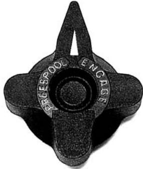
2. Pour embrayer le tambour, tourner le bouton à la position « ENGAGED » (embrayé). Lorsque l'embrayage est en position « ENGAGED », la flèche sur le bouton d'embrayage est orientée vers « ENGAGED » sur l'autocollant du treuil. Le treuil est maintenant prêt à tirer.
