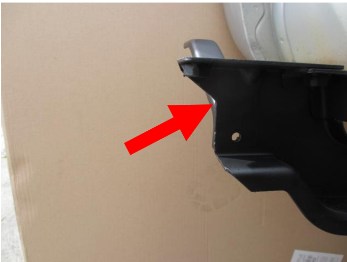
Abb. 14: Halter Stoßstange anpassen
