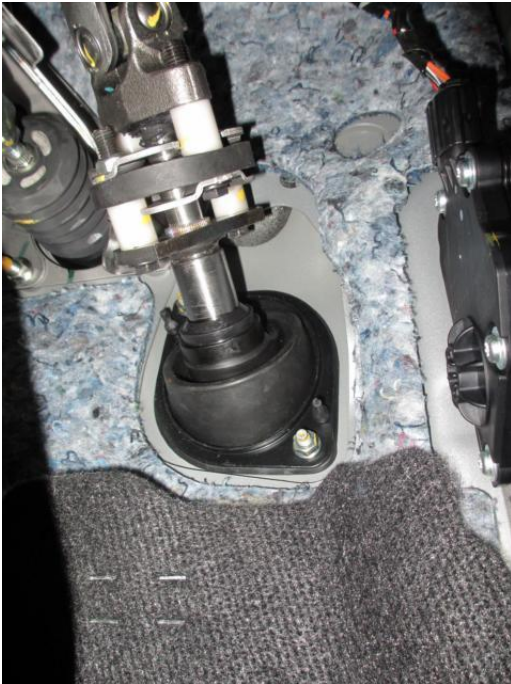
Abb. 1: Längere Lenkwelle verbauen
