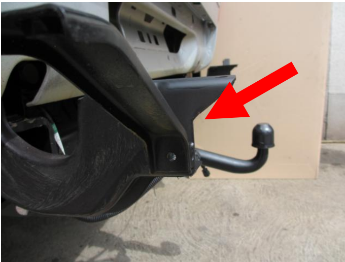
Abb. 13: Halter Stoßstange anpassen
