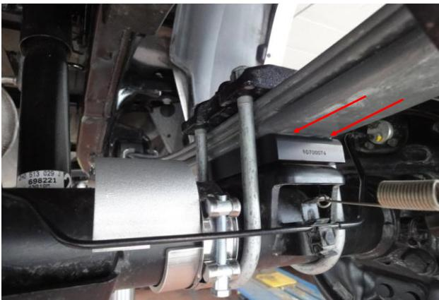
Achse absenken und Distanzklötze von 25 mm mit Rundung nach oben unterlegen. Achse anheben und auf richtigen Sitz der Führungsbolzen achten. Achse, Blattfeder und Federspannplatte mit mitgelieferten neuen Federbügeln und Muttern verschrauben. Anziehdrehmoment laut Werksangaben.
