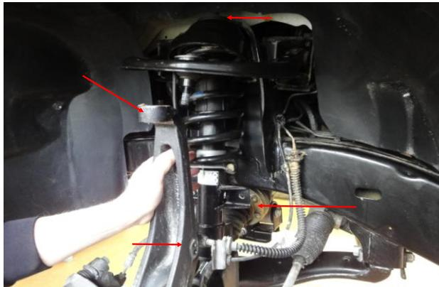
Umgebautes Federbein wieder einbauen und Führungsgelenk am Querlenker oben, Befestigungsmutter am Stoßdämpfer oben, Antriebswelle am Vorderachsgetriebe und Bremsleitungshalter wieder nach Werksangaben festziehen.
