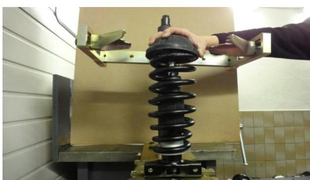
Federbein zerlegen und Feder austauschen. Anlagefläche der Feder am Federteller mit Gleitmittel bestreichen und Federbein laut Werksangaben komplettieren.
