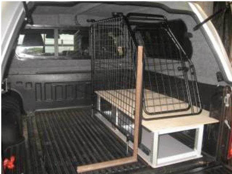
Die Schublade wird aus der Konsole ausgebaut, und an den gekennzeichneten Stellen durch den Pritschenboden gebohrt und verschraubt. Der mitgelieferte Distanzstreifen aus Phenolharzplatte wird zwischen Kastenboden und Kunststoffwanne in die Sikke eingelegt um beim Schrauben einen besseren Verbund zu haben.
