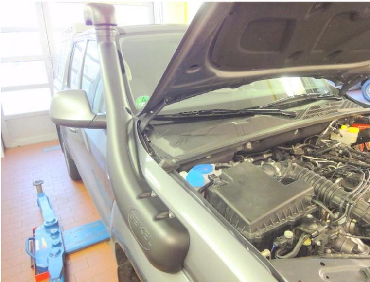
Beide Luftfiltergehäuse befestigen, alle Schlauchverbindungen an ihren originalen Punkten wieder einhängen und Radhaus rechts wieder komplettieren.
