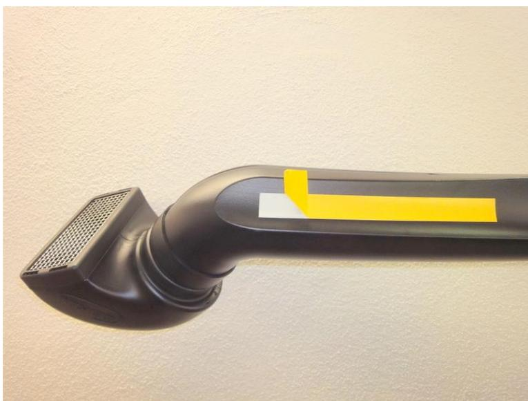
Schutzstreifen an Klebefolie wie im Bild rechts leicht abziehen und nach außen umlegen. Fahrzeugkarosserie im Bereich des Klebestreifens reinigen und entfetten.
