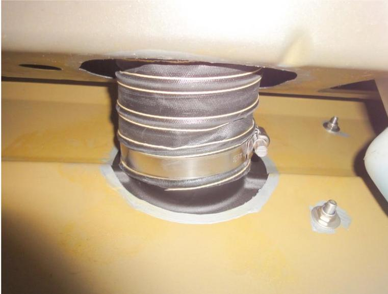
Luftfiltergehäuse durch die angefertigte Motorraumöffnung zum Ansaugrohr positionieren, Schlauchstutzen scheuerfrei verlegen und am Ansaugrohr mittels Schlauchschelle befestigen.
