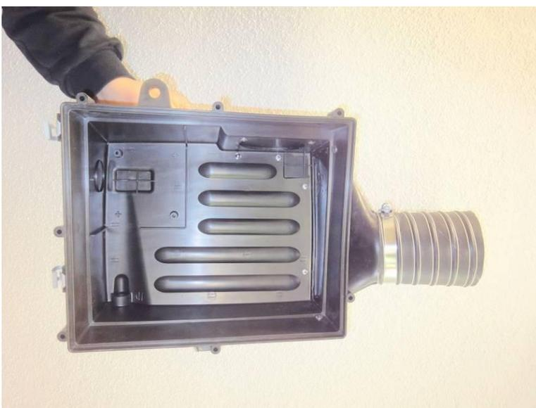
Schlauchstutzen mit mitgelieferter Schelle an unterem Luftfiltergehäuse befestigen.
