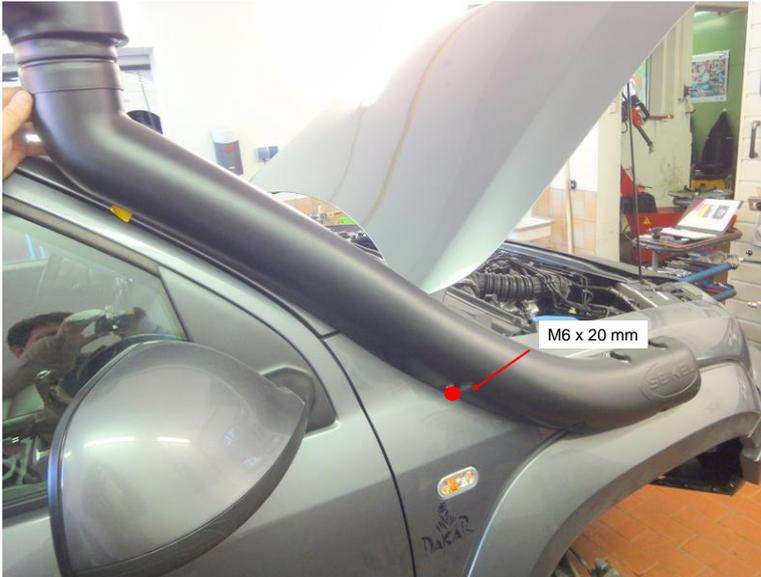
Ansaugrohr mit 3 x M6 x 20 und 1 x M6 x 30 mit U-Scheiben und Muttern an Kotflügel ausrichten. Beide noch fehlenden Schrauben M6 x 20 mm in Einriemuttern eindrehen, Ansaugrohr am A-Holm ausrichten und Schutzfolie rausziehen, beide oberen Schrauben festziehen.
