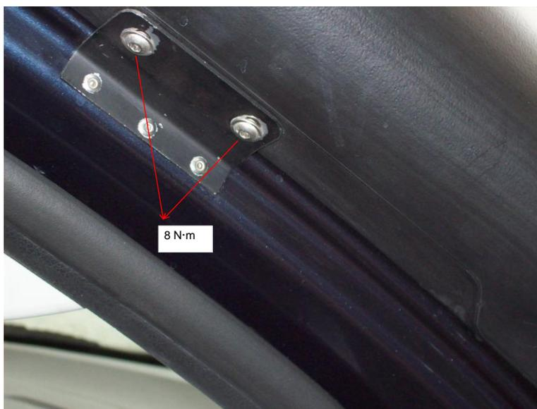
Halter mit dem Rohr verschrauben, Schrauben noch nicht endgültig festziehen.
