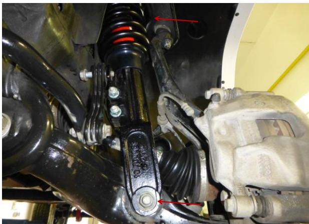
Stabilisator am Federbein und Klemmschraube am Stoßdämpfer unten nach Werksangaben festziehen.
