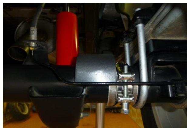
Befestigungsschelle über die Anschlagverlängerung und Halbschale schieben und festschrauben.
