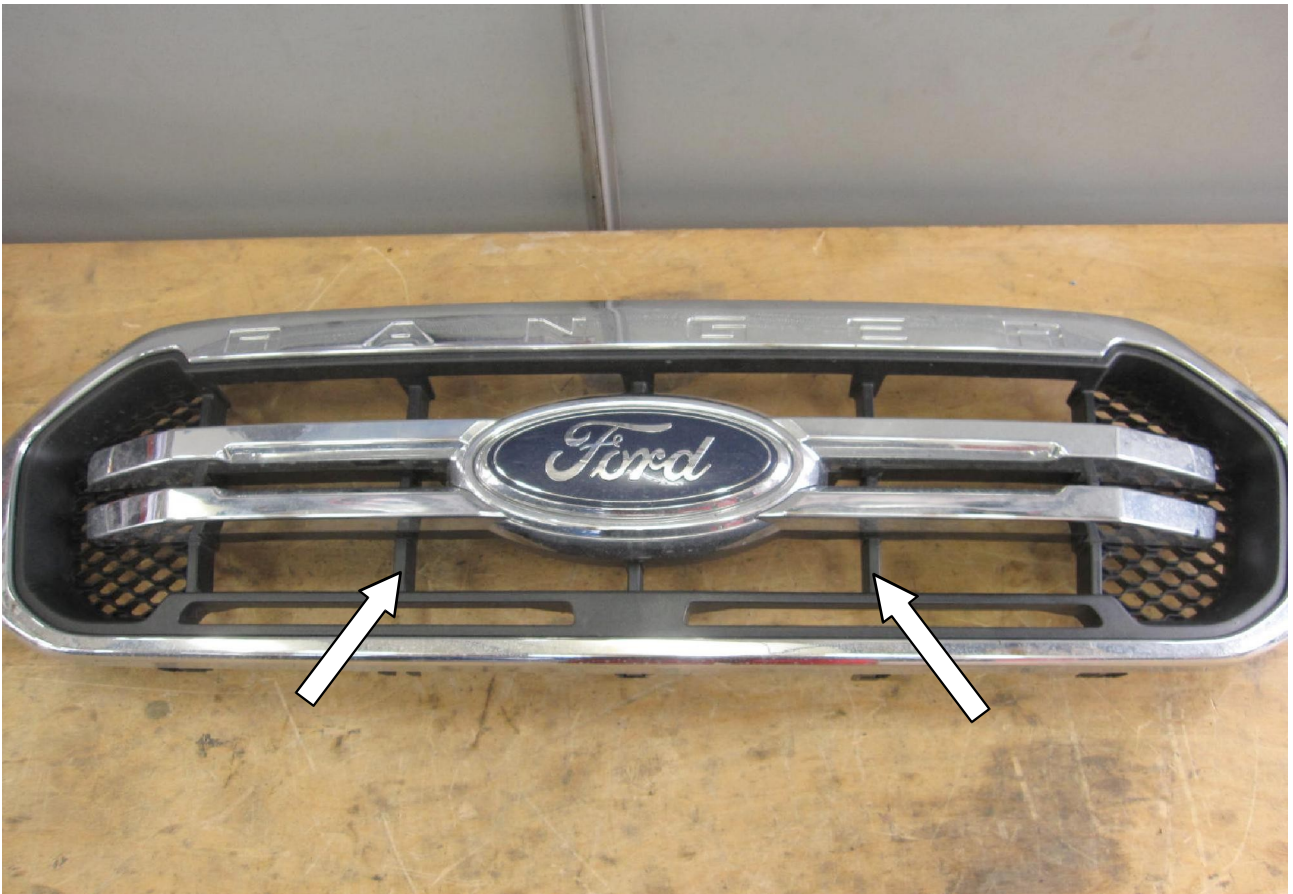
7 Strebe herausschneiden! / Cut out the strut!
