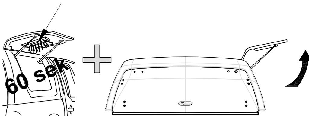
Beim oeffnen der Seitenklappe die Innenleuchte schaltet automatisch fuer 60sek. ein.
