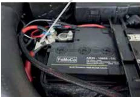
Kabel **Masse** an Karosseriemassepunkt mitschrauben
