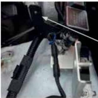
Halter Steuerbox mit Fahrzeughalter mit-schrauben.
