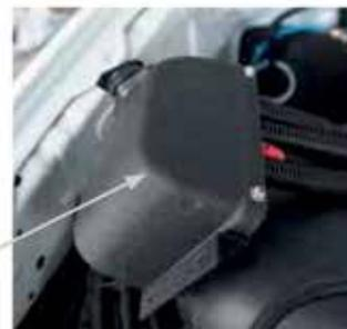
Deckel auf Steuerbox montieren und an vormontierten Halter anbringen.
