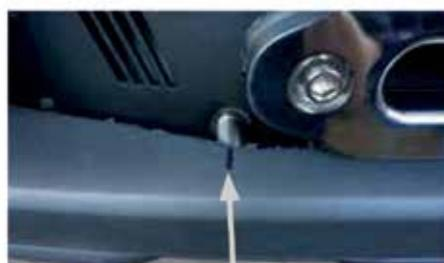
Ausgeschnittene Stoßstange ans Fahrzeug halten und Position vom Freilauf markieren.
