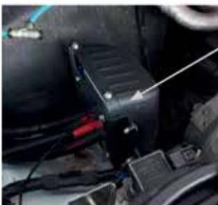
Ausgleichsbehälter wieder in das Fahrzeug einbauen.
