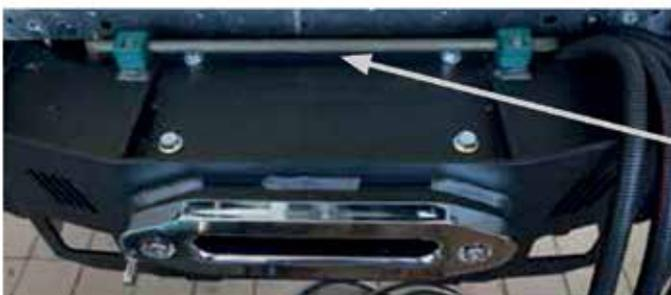
Hydraulikleitung mit den mitgelieferten Rohrschellen an der Platte befestigen.
