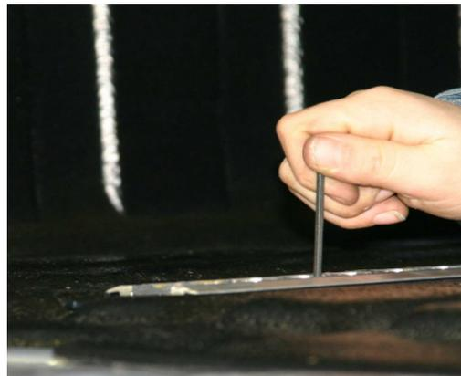
Montieren Sie die Bodenschienen mit Hilfe der mitgelieferten Senkkopfschrauben, Unterlegscheiben und Selbstsichernden Muttern.
