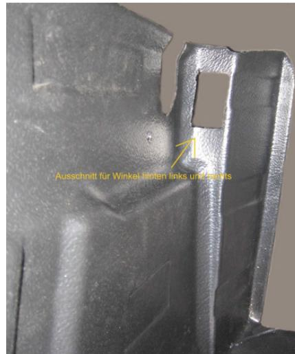
Setzen Sie die LW erneut ein. Beginnen Sie mit einem Seitenteil und lassen die LW in die Ladefläche rutschen. Sind die Ausschnitte für die Haltewinkel richtig, bringen Sie durch Anheben des Bodenteils der LW die 2. Seite unter die Bordwandkante. Wenn alle Ausschnitte passen können Sie mit der Bohrung des Bodenschienenausschnittes beginnen. Passen die Seitenteile noch nicht spannungsfrei, entfernen Sie die LW und überarbeiten die Ausschnitte erneut. LW muss spannungsfrei in der Ladefläche liegen.
