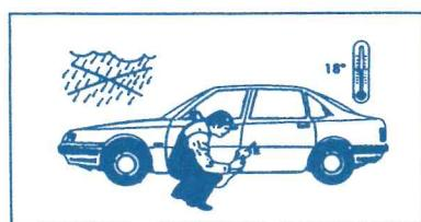
ACHTUNG: die Zierleisten nicht bei einer Temperatur unter 18°C montieren. Wenn die Montage doch notwendig sein sollte, dann beide Komponenten kurz mit einem Föhn erwärmen (Leisten und Karosserie).
