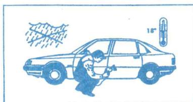
**ATTENZIONE:** non montate le strisce protettive ad una temperatura inferiore ai 18°; se il montaggio è assolutamente necessario, scaldate le due parti (le strisce e la carrozzeria) con un asciuga capelli.
